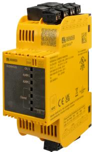
LINETRAXX® SmartDetect RCMS425-Lは、接地された電源システム向けの、AC、パルスDC、およびスムーズDCに対応する残留電流モニターです。直流電圧および交流電圧の両方で、2 mAから70 Aの残留電流を、15 Hzから20 kHzの周波数範囲で測定します。
